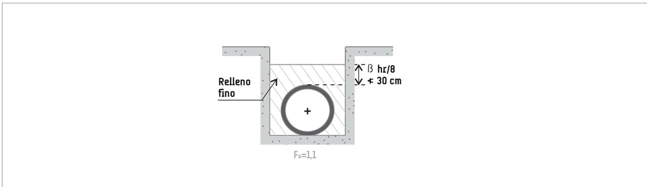
\*El factor de apoyo directo se podrá utilizar cuando no exista material de aportación y con el fondo de zanjas rastrillado. Nunca se podrá utilizar el apoyo directo sobre hormigón. Siempre será requerido ejecutar nichos para el alojamiento de las campanas si el tubo presenta un sobreebanco en la zona de la unión.
