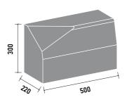
Resistencia a la flexión Clase 2 Marcado T ( ≥ 4 MPa) Absorción de agua Clase 2 Marcado B ( ≤ 6 %) Desgaste por abrasión Clase 3 marcado H ( ≤ 23 mm) Norma EN 1340 Norma UNE 127340
