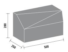
Resistencia a la flexión Clase 2 Marcado T ( ≥ 5 MPa) Absorción de agua Clase 2 Marcado B ( ≤ 6 %) Desgaste por abrasión Clase 3 marcado H ( ≤ 23 mm) Norma EN 1340 Norma UNE 127340 ( (
