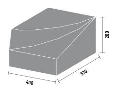
Resistencia a la flexión Clase 2 Marcado T ( ≥ 4 MPa) Absorción de agua Clase 2 Marcado B ( ≤ 6 %) Desgaste por abrasión Clase 3 marcado H ( ≤ 23 mm) Norma EN 1340 Norma UNE 127340
