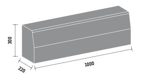
Resistencia a la flexión Clase 2 Marcado T ( ≥ 4 MPa) Absorción de agua Clase 2 Marcado B ( ≤ 6 %) Desgaste por abrasión Clase 3 marcado H ( ≤ 23 mm) Norma EN 1339 Norma UNE 127339 ( (
