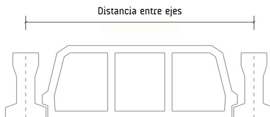
Para una distancia entre ejes de viguetas de 600 mm
