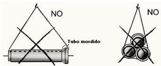
Figura 10. Forma inadecuada de descarga de tubos
